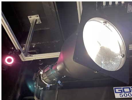
(d) Collimated-Beam Light Source and VICON Motion Capture System
